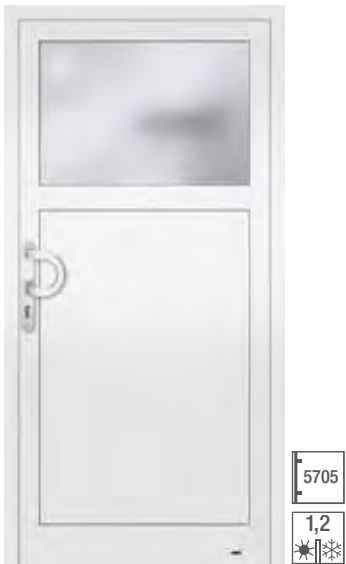
5506-1 ADVANCE 75 mit 100 mm Glasleistensprosse, Verglasung: Wärmeschutzisoliertes Glas vorne VSG beschichtet, hinten: Mastercarre, Alternativ: Float oder Chinchilla weiß, unten wärmeisoliertes Alu-Sandwich-Paneel, 30 mm stark. Oberfläche: RAL 9016 Verkehrsweiß
