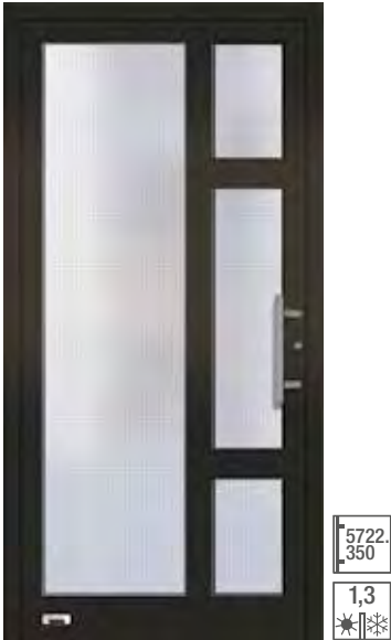
5505 geteilte Sprossen 90 mm, Wärmeschutzisoliertes Glas, vorne: VSG beschichtet, hinten: Mastercarre, alternativ: Float oder Chinchilla weiß. Oberfläche: Sandbrown FSM
