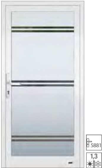
5512 ADVANCE 75 Verglasung: Wärmeschutzisoliertes Glas, vorne: VSG mattiert mit klaren Streifen hinten: Float beschichtet; Oberfläche: ca. RAL 9016 Snow FS beidseitig Drücker 5881 aus Aluminium in weiß oder silberfarbig.
